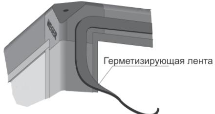
На гигиенических установках в ходе их сборки на месте в их нижней припольной зоне следует закрыть канавки, разделяющие части корпуса, герметизирующим составом, устойчивым к воздействию дезинфицирующих средств.
